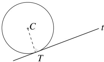
**Remarque finale :** Si l'on veut calculer les coordonnées des points de tangence connaissant les équations du cercle et des 2 tangentes, la méthode la plus rapide consiste à utiliser la perpendiculaire à la tangente, passant par le centre du cercle.
